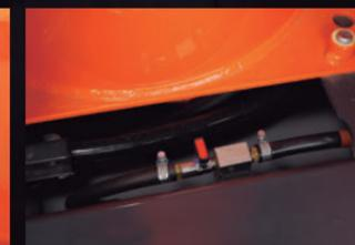
容易な燃料タンクの水抜き
